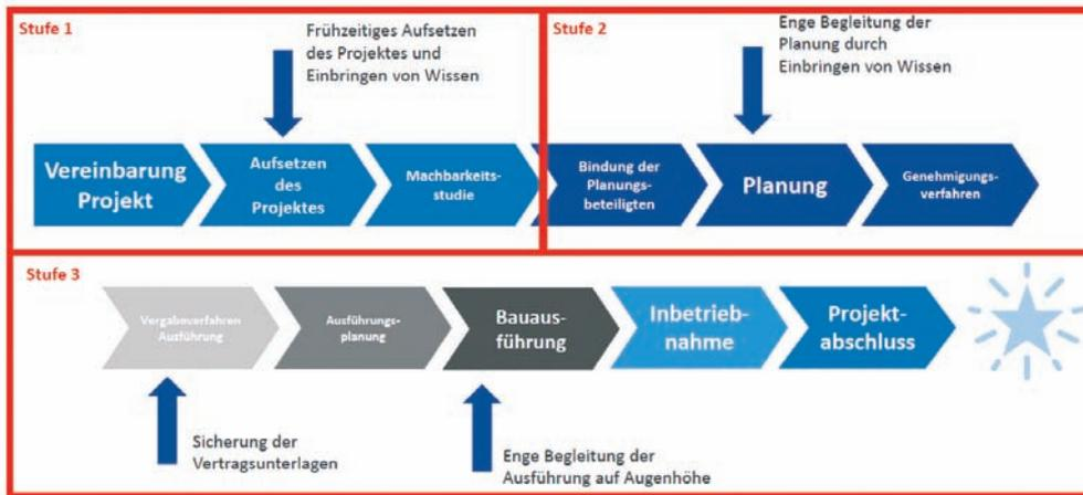
3 Fuß- und Radwegebrücken am Main - Stufenweise Abwicklung zur strukturierten Projektumsetzung
